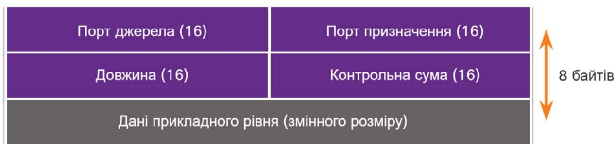
Рис. 8.7. Поля заголовка UDP
