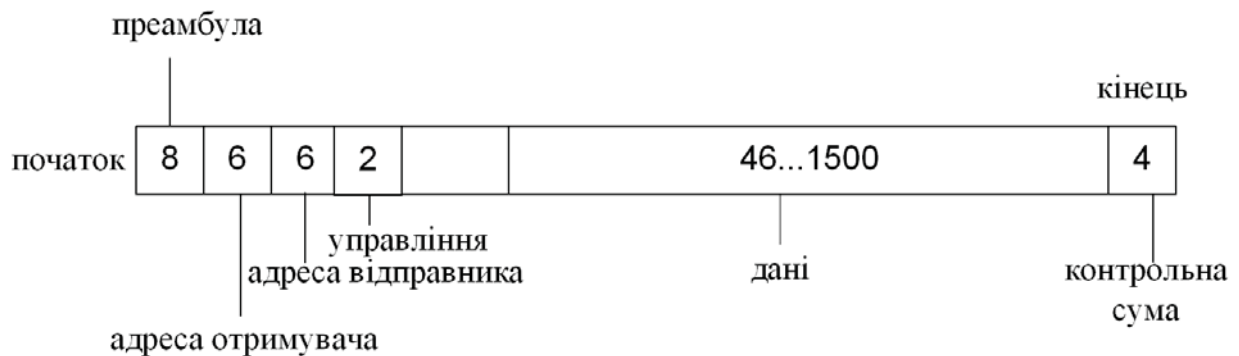
Рис. 4.3. Структура кадру мережі Ethernet
