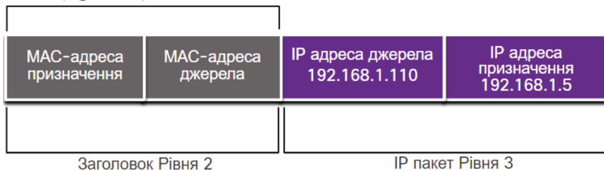
Рис. 3.1. Адреси канального рівня
