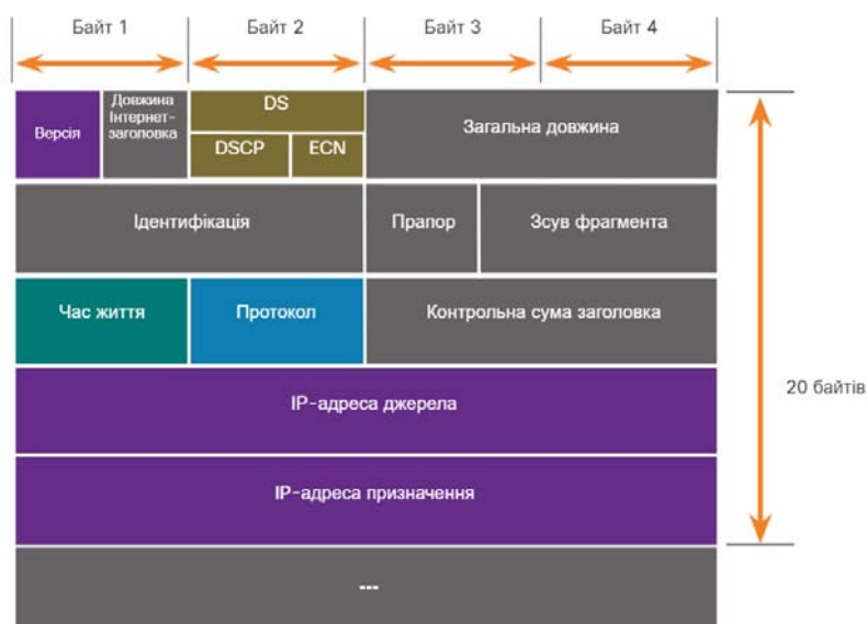
Рис. 5.1. Поля заголовку пакета IPv4
