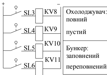
Рис. 3.8. Принципова електрична схема керування ОПК-2 (датчики рівня)
