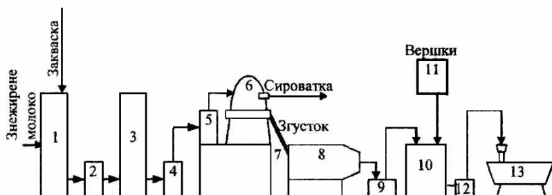
Рис. 5.16. Схема лінії виробництва сиру роздільним способом
