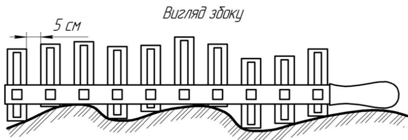
Рисунок 10.5 – Вимірювання гребенястості поверхні ріллі за допомогою профілеміра
