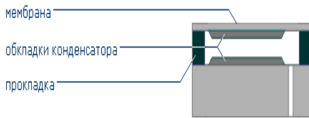
Мал. 3 - Ємнісний перетворювач тиску.
