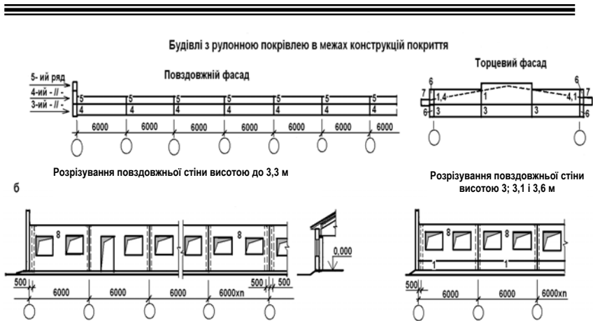
Рис. 2.4.7. Схеми розрізування панельних стін:
