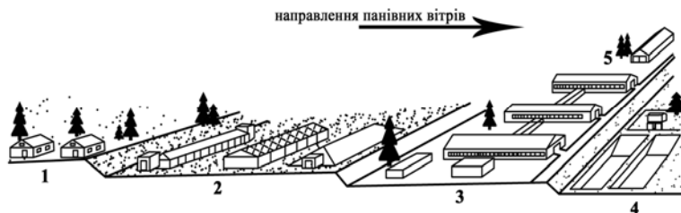
Рис. 1.2.2. Схема розміщення будівель і споруд різного призначення з урахуванням рельєфу місцевості і панівних вітрів:
