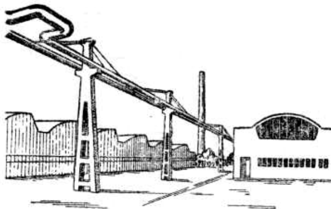
Мал.4.34. Надземне прокладання теплових мереж на опорах
