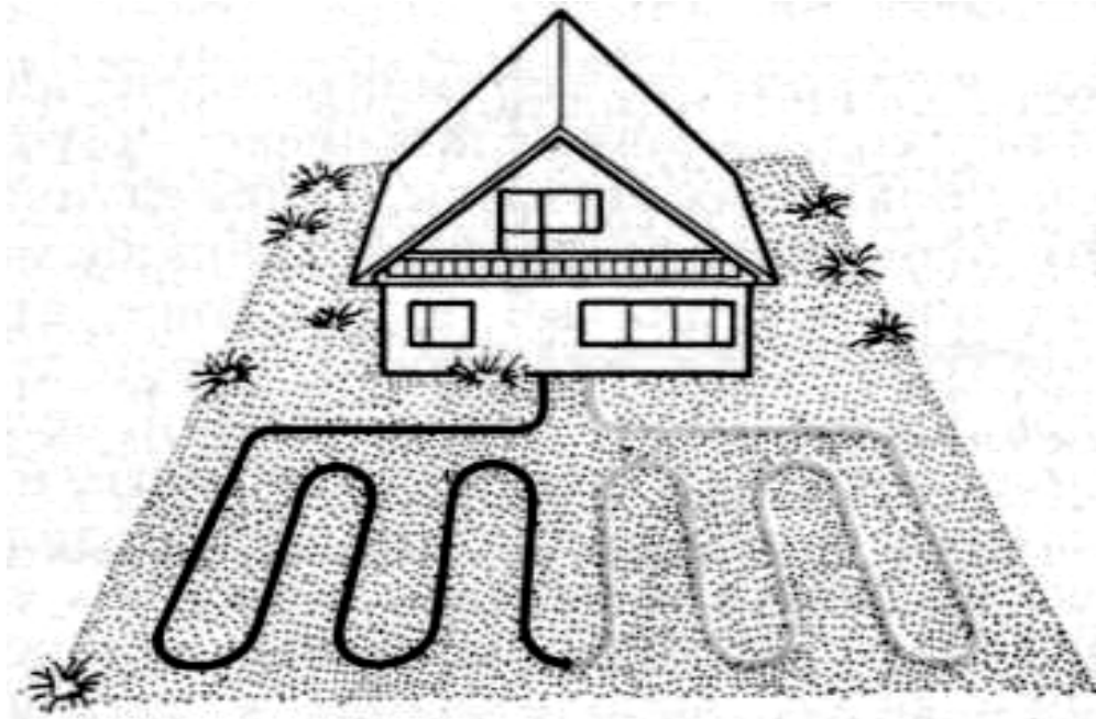
Мал.7.18. Схема влаштування горизонтального ґрунтового низькопотенціального колектора
