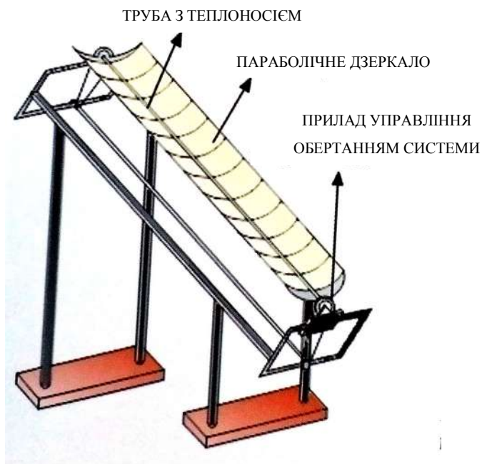
Рис. 2.10. Схема сонячного колектора-концентратора
