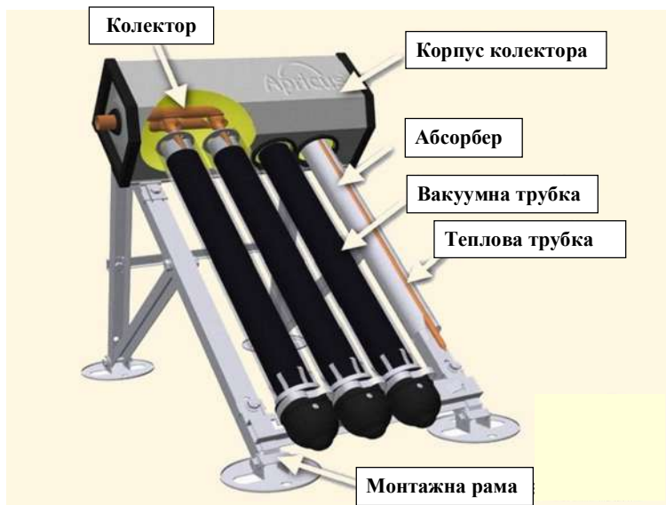
Рис. 2.9. Будова вакуумного сонячного колектора
