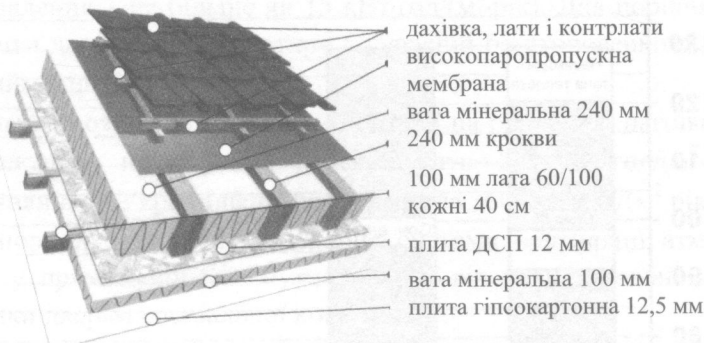
Рис. 7.5. Розріз стіни (а) та даху (б) пасивного будинку
