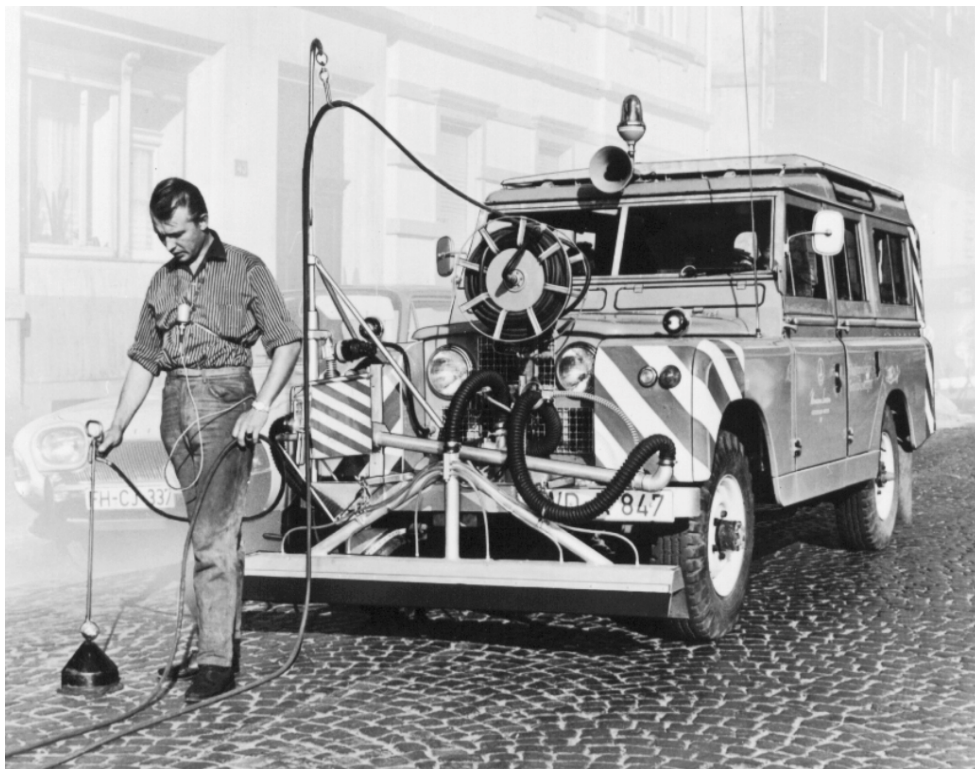
Рис.64 – Автомобіль із системою “відсмоктування” витоків газу
