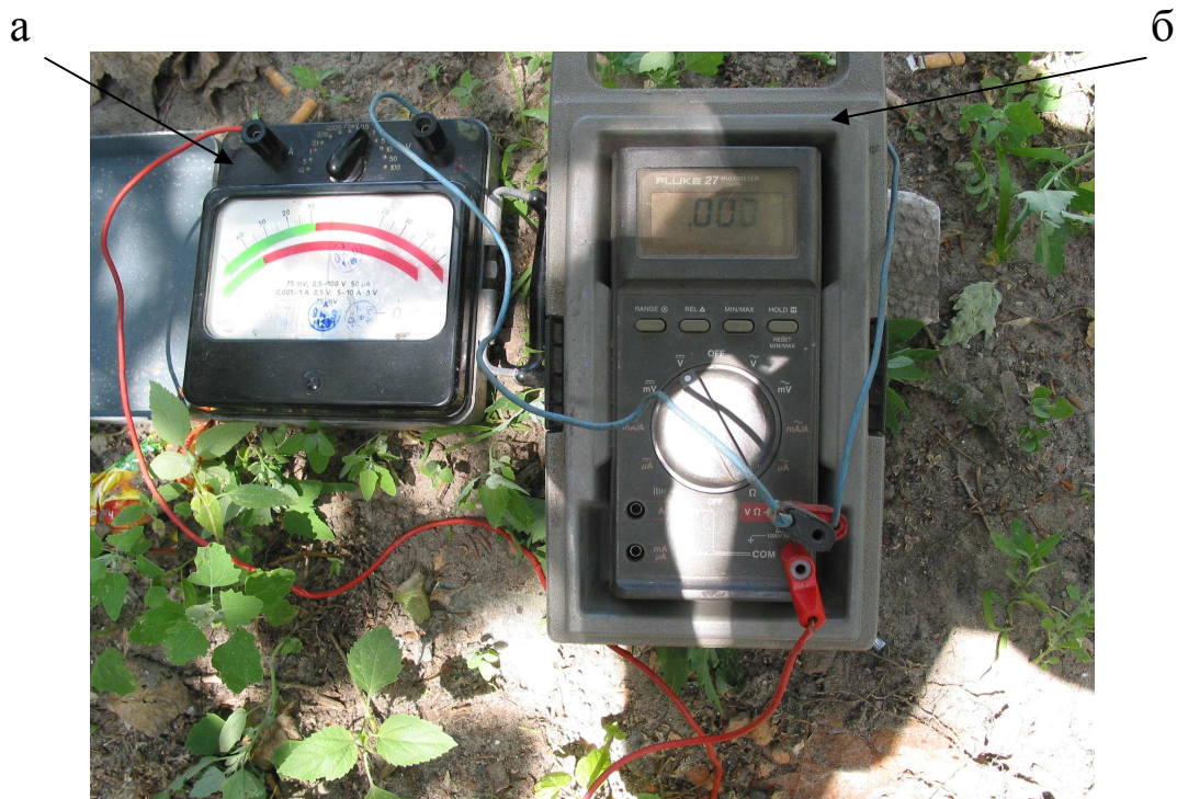
Рис. 70 – а – ампервольтметр М- 231; б- мультиметр FLUKE
