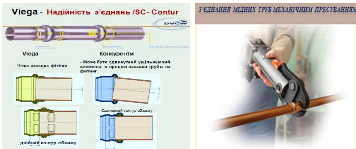
Рисунок 4.26 – Надійність з'єднання мідних труб прес-інструментом Viega-PT3
