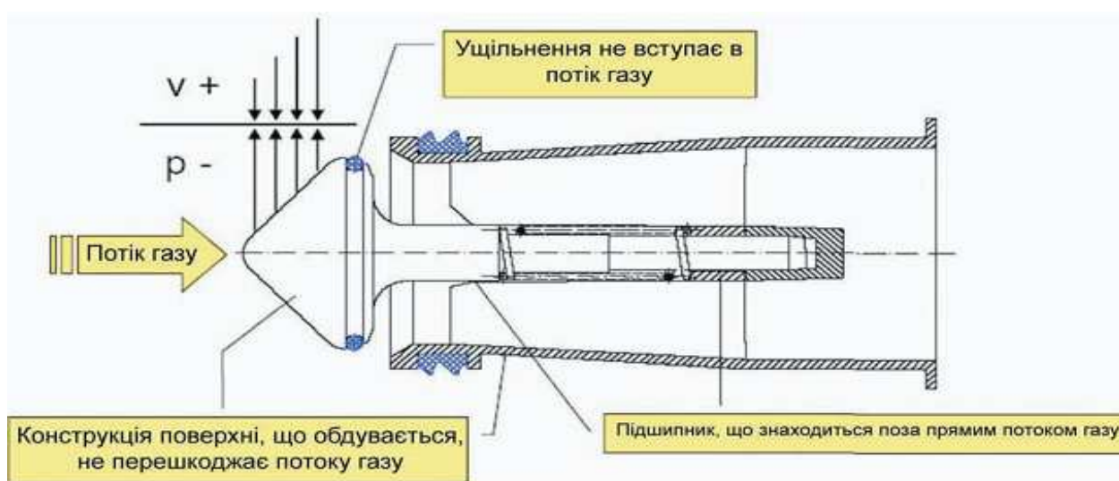
Рисунок 5 – Будова клапану «Газ-стоп»
