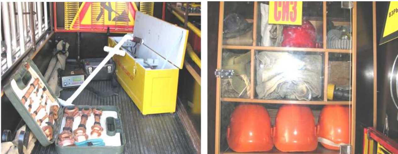
Рисунок 1.39 – Комплект інструмента, прилади, засоби захисту в СААГС
