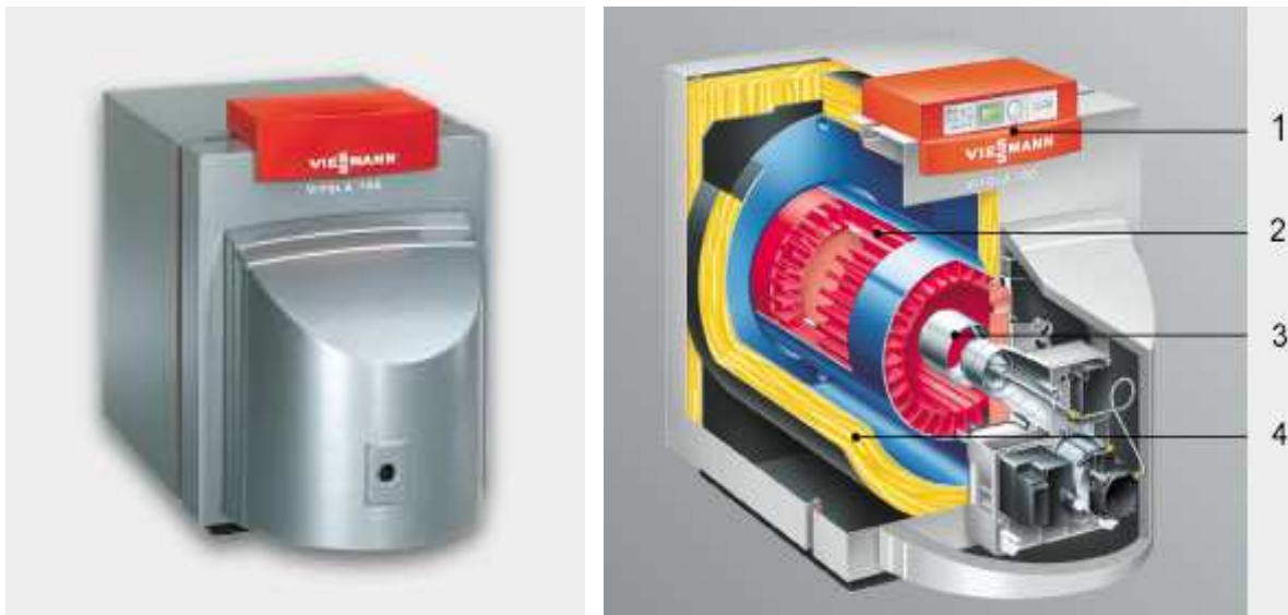
Рисунок 3.18 – Низькотемпературний водогрійний котел Vitola 100 Котел у розрізі: 1 – Цифровий контролер Vitotronic 100; 2 – Теплообмінні поверхні Comferral; 3 – Рідкопаливний пальник Vitoflame 200; 4 – Високоєфективна теплоізоляція
