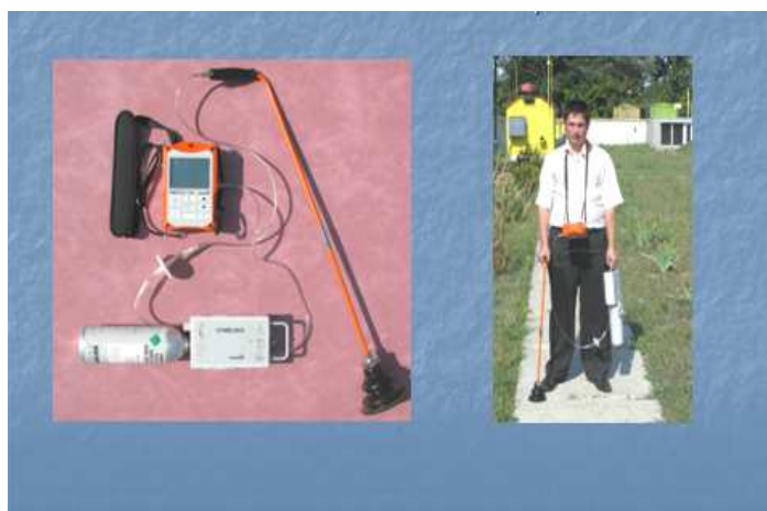
Рисунок 1.42 – «Варіотек-9 EX» в комплекті с ETHAN-BOX
