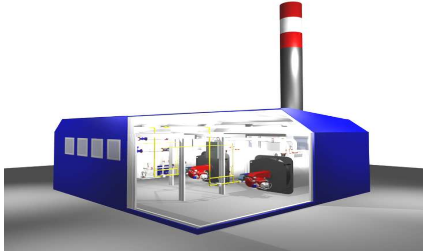
Рисунок 3.31 – Блочно-модульна котельня (БМК)
