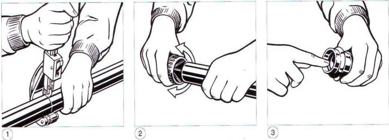
Рисунок 4.28 – Технологія монтажу мідних труб Profipress G (пункти 1-3)
