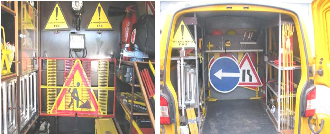
Рисунок 1.38 – Варіанти комплектації вантажного відсіка СААГС
