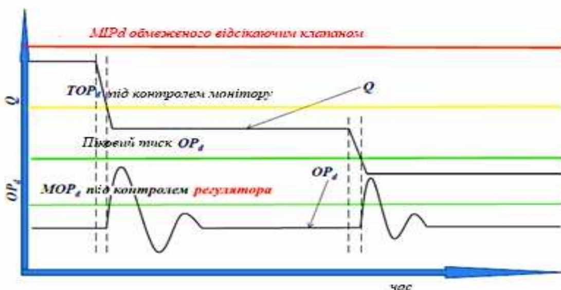
Рисунок 2.79 – Зміна регульованого тиску OPd при різкому зменшенні витрати газу для однієї лінії редукування при нормальних умовах роботи
