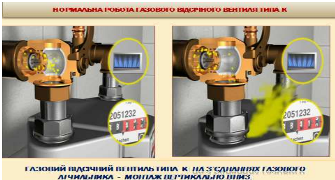
Рисунок 4.36 – Нормальна робота газового відсічного вентиля типа К
