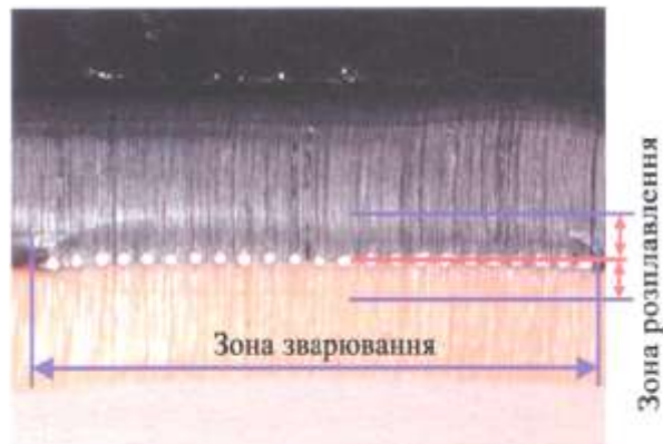
Рис. 2.62 – Термічне розширення матеріалу при з'єднанні труби з муфтою з відкритою спіраллю
