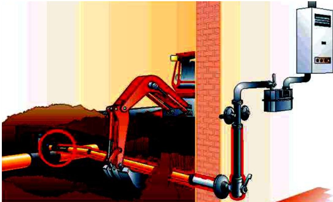
Рис. 2.39 – Пошкодження газопроводу-вводу екскаватором при земляних роботах на розподільних газопроводах
