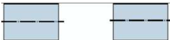
Рис. 2.43 – Візання пошкодженої ділянки
