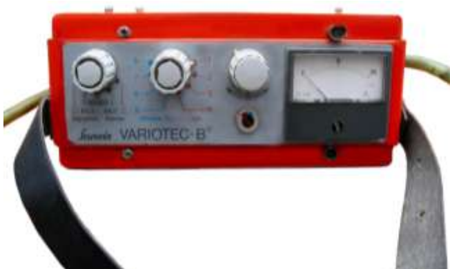
Рис. 1.45 – Газоіндикатор "Варіотек-В": 1 – вимикач; 2 – перемикач діапазонів; 3 – потенціометр настроювання нуля; 4 – індикатор зарядки акумулятора; 5 – штуцер; 6 – гніздо для підключення зарядного пристрою; 7 – корпус
