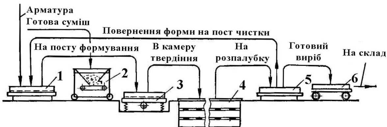
Рис. 14.7 – Технологічна схема агрегатно-поточного процесу виробництва залізобетонних виробів
