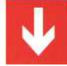
Напрямок до місця розташування обладнання для пожежогасіння або пристрою оповіщення
