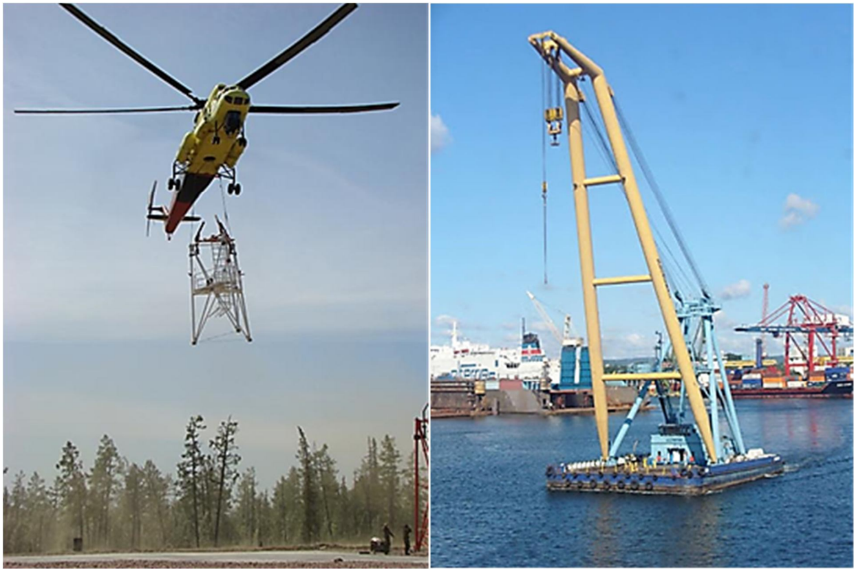
Рисунок 3.12 – Літаючий і плавучий крани
