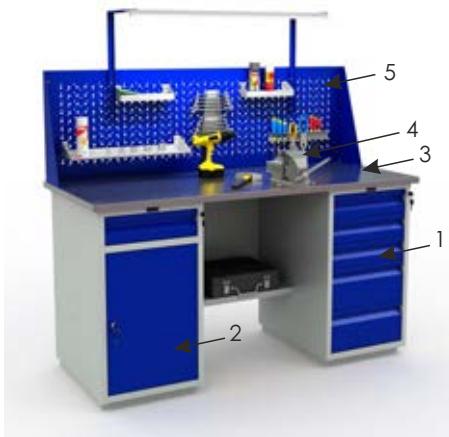
Мал. 1. Слюсарний одномісний верстак з поворотними лещатами: 1 – висувні ящики; 2 – тумба; 3 – стільниця; 4 – лещата; 5 – місце для закріплення інструментів
