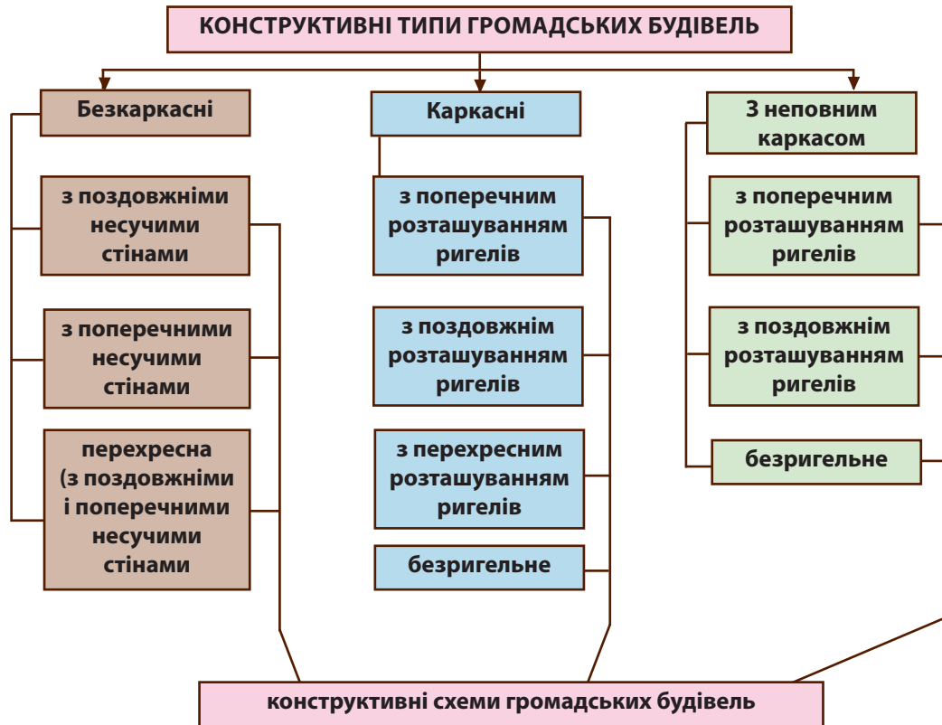
Рис. 2.2.1. Схема конструктивних типів та схем громадських будівель
