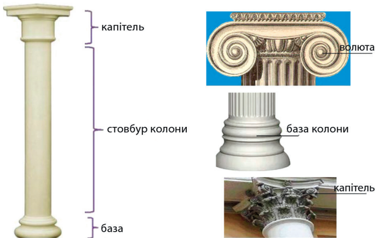
Рис. 4.5.6. Колона та її основні частини
