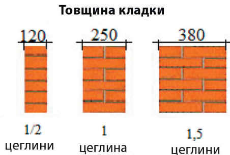
Рис. 4.2.2. Товщина стін цегляної кладки
