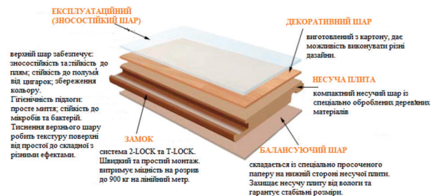
Рис. 6.1.9. Шари ламінованого покриття
