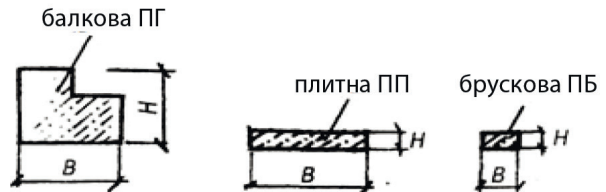
Рис. 4.5.10. Елементи збірних залізобетонних перемичок
