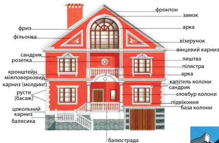
Рис. 4.5.1. Назва та розташування архітектурних деталей
