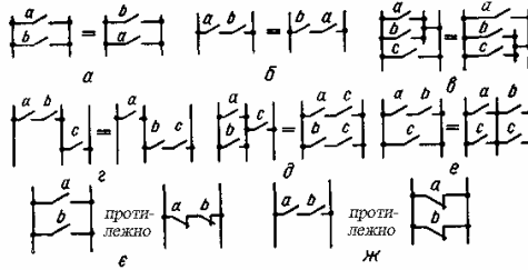
a, б – переставний закон; в, з – сполучний закон; д, е – розподільний; є, ж – інверсії
