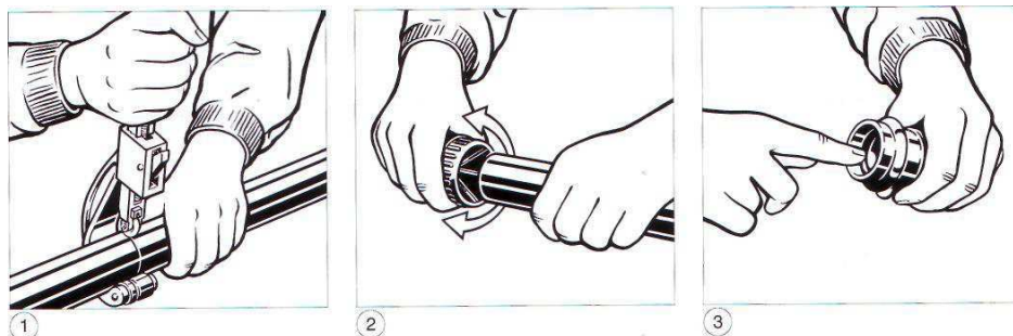
Рисунок 5.6 – Технологія монтажу мідних труб Profipress G (пункти 1-3)
