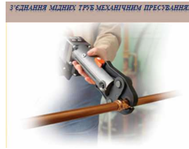
Рисунок 5.4 – Надійність з'єднання мідних труб прес-інструментом Viega-PT3
