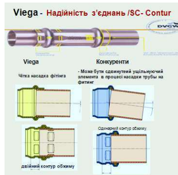
Рисунок 5.4 – Надійність з'єднання мідних труб прес-інструментом Viega-PT3
